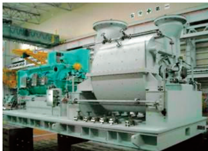
送風機 石油精製所向け（硫黄回収設備用） エアブロウ
