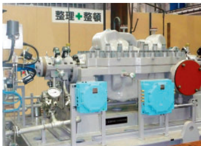
ポンプ 石油精製所向け 原油移送ポンプ
