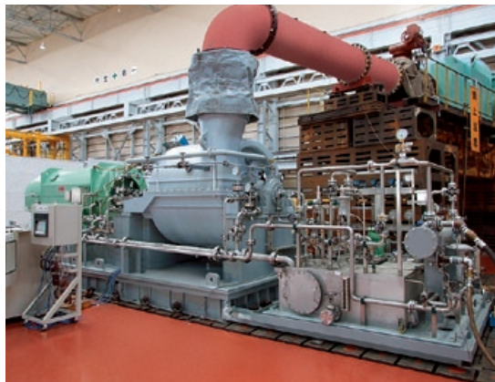
● 工場試運転中の硫黄回収用多段ブロワ
