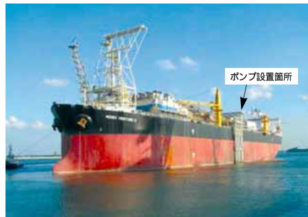
図10 FPSOと海水取水ポンプ
