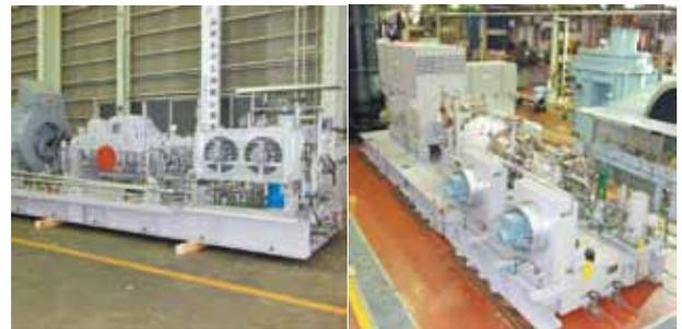
図5 API610対応高圧ポンプ (左側BB3、右側BB5)
