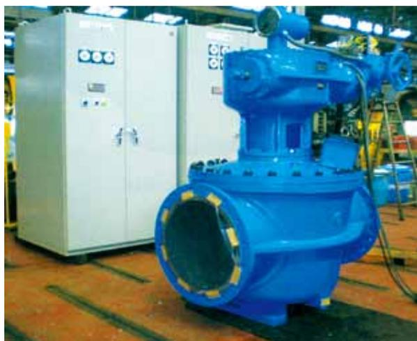
図12 ロート弁とサーボモータ制御盤の外観
