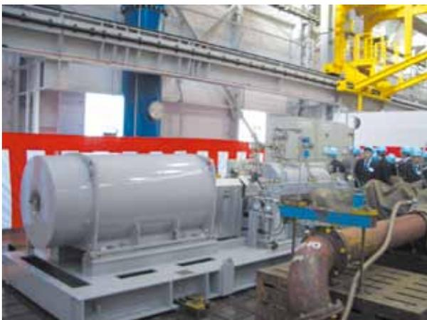
図1 水平二ツ割横軸高圧多段ポンプの運転状況
