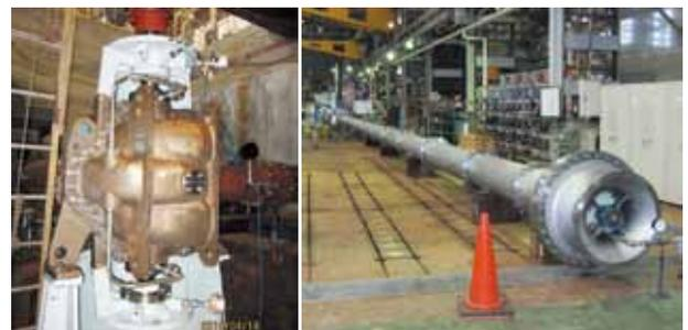
図6 API610対応VDF-2F外観 (左側BB1) とVPFC外観 (右側VS1)
