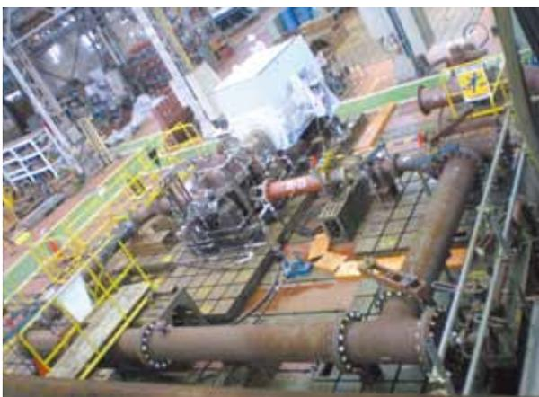
図5 工場試運転中の低圧ドレンポンプ
