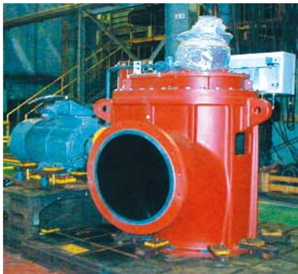
図6 90度直角方向吐出しラムダ21の外観
