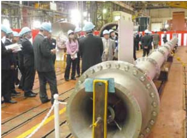
図6 立軸斜流ポンプ（床下長尺型）の説明状況
