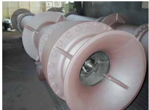
図6 原子炉補機冷却海水ポンプ
