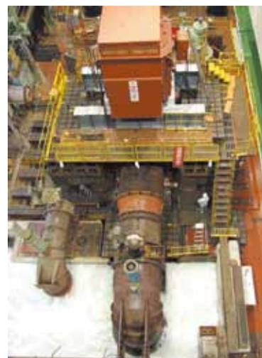
図2 工場試運転中の循環水ポンプ
