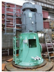
バイオマス発電用循環水ポンプ
