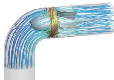
ポンプの流れ解析シミュレーション
