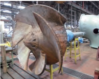
使用後約20年が経過したポンプ羽根車
