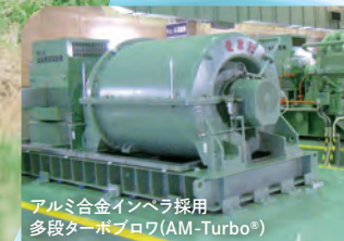
アルミ合金インペラ採用 多段ターボブロウ (AM-Turbo®)
