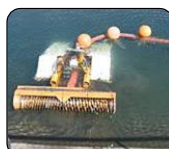
水中排砂ロボット
