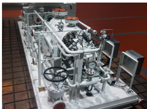
●工場試運転時の高圧多段ポンプ
