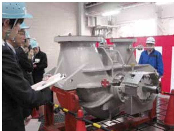
図2 両吸込プロセスポンプの展示状況
