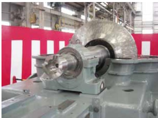
図6 水平二ツ割両吸込単段ブロワの展示状況
