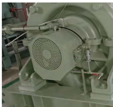
図5 空冷式ころがり軸受ユニット Fig.5 Air-cooled ball bearing unit
