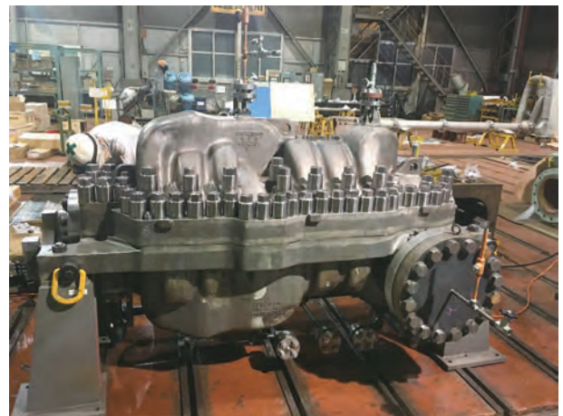
図5 ケーシング耐圧試験 Fig.5 Hydrostatic Test of Casing
