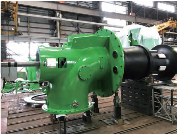
図5 循環水ポンプ外観
