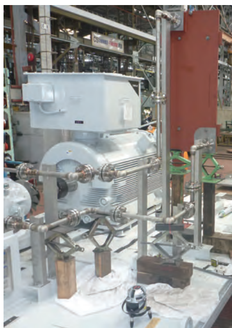
図 2 Plan53B シールシステム小配管施工
