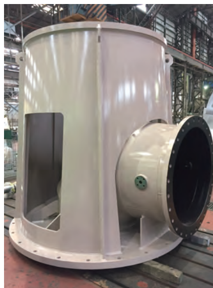
図3 循環水ポンプ吐出しエルボ外観
