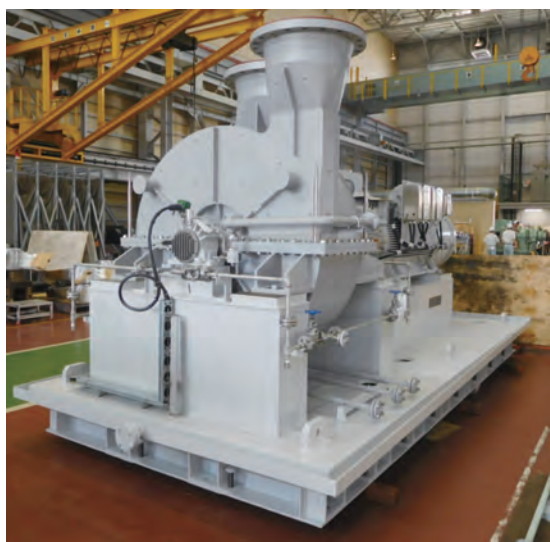
図3 CO 2 Raw Gas Blower 外観
